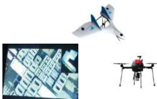
<建材の在庫を上空から撮影>
