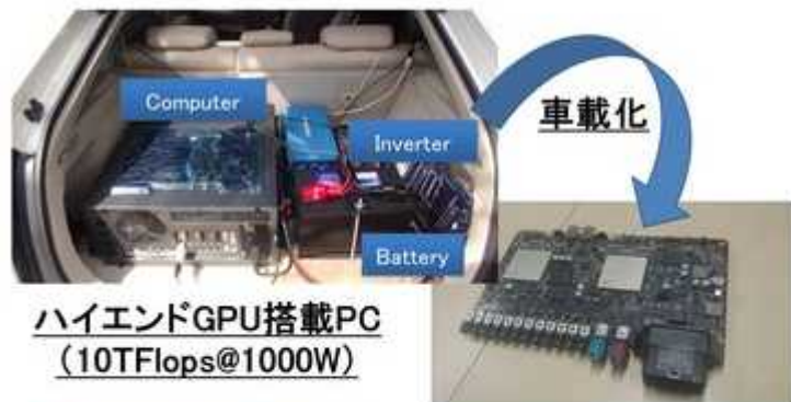
組み込みGPU搭載Drive PX (1TFlops@10W)
