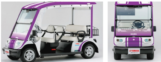
(株)ティアフォー、ヤマハモーターパワープロダクツ(YMPC)、(株)マクニカが提供する「アカデミックバックPRO」 自動運転開発用のプラットフォーム https://jidouten-lab.com/w_academic-pro-autonomous-car より引用
