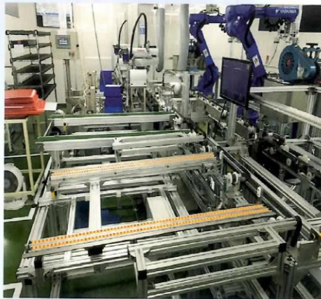
机械臂焊接&品质检测生产线
