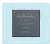
図6 米SiFiveのRISC-V Core IP を使った ArchiTek(株) Edge AI Processor "AiOnIc" 諸元 10)
