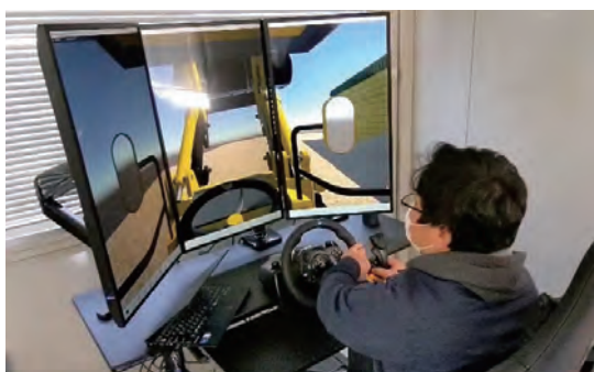
図3-2 デジタルツインで建機を遠隔操作
