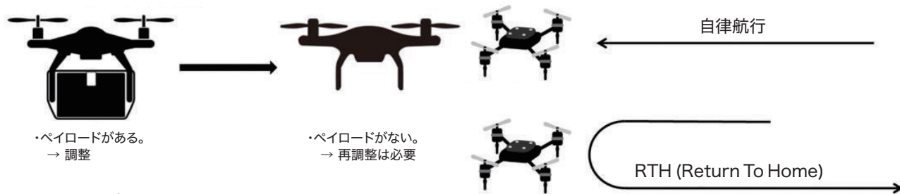
図6 ドローン利用事の安全制約の要約
