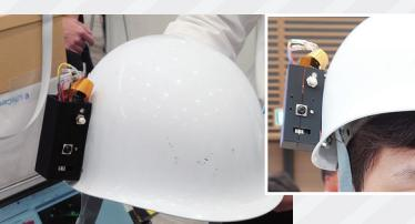
▲災害現場の隊員の体調をチェックする『疲労検知ヒューマンレコーダー』。体の“揺れ”で疲労度を測り警鐘する。
