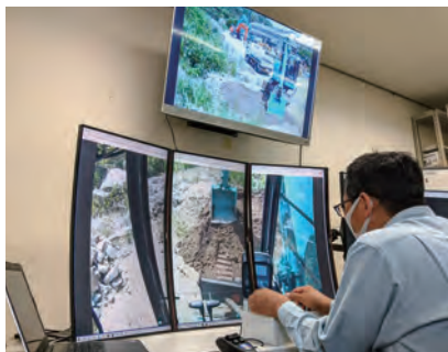
インターネットに接続した環境であればどこからでも遠隔操作可能に。 左は遠隔操作でダンプトラックに土砂を積んでいる様子。
