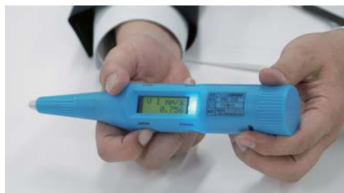
▲ISOシビアリティ判定機能を備える振動チェッカー。4段階の色で状態を即時判定する
