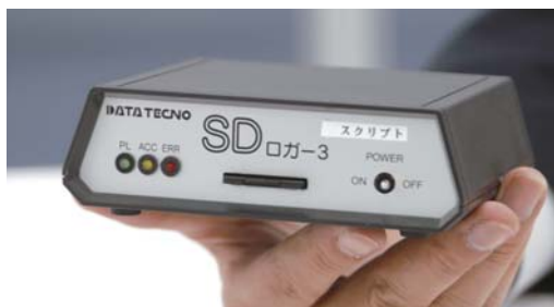
▲PCを介さずシリアルデータをSDカードに記録するSDロガー
