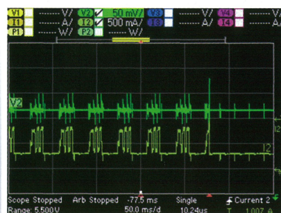
[図2-1] オシロスコープによる電源ノイズの測定画面
