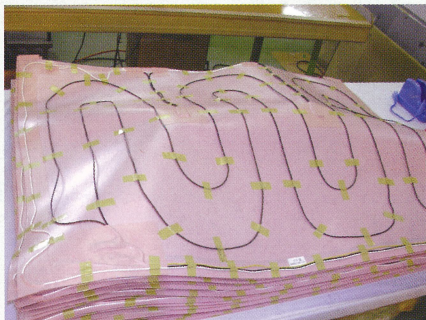
【写真2】センサーを貼り付けた線面発熱体
