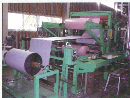
【写真4】 線面発熱体製造装置
